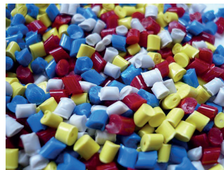
Granules de polymères utilisés en mise en œuvre pour obtenir des objets en matière plastique
